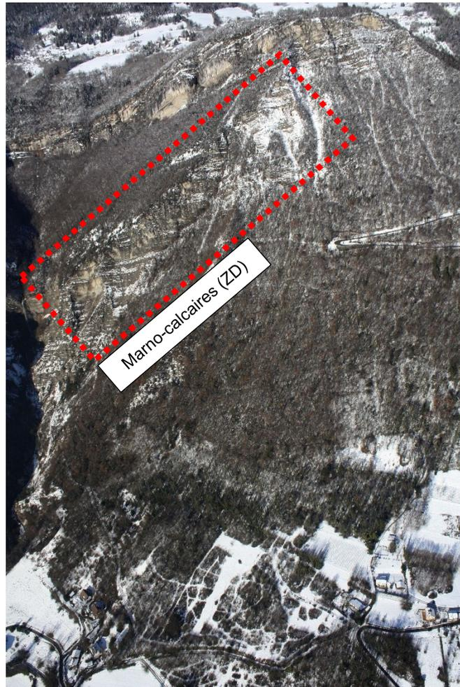
Figure 19 : Repérage des marno-calcaires sur le versant du Belvédère du Puy
