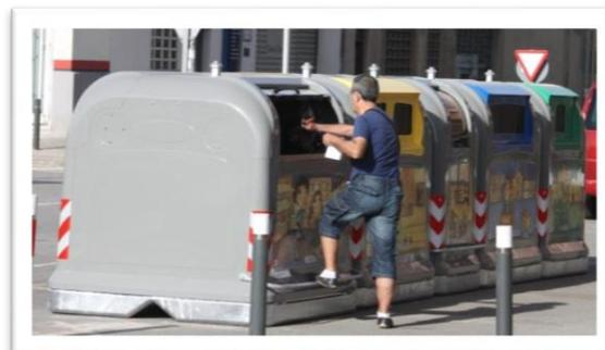
Le positionnement de la trappe à 120 cm permet un accès des bornes aux personnes à mobilité réduite.
